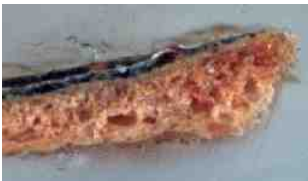
Imatge de microscòpia òptica on s'observa una capa blava amb grans de color vermells, blaus i blancs per sobre d'una fina capa blanca.
